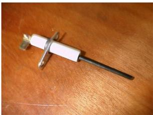
In der Flamme kann sich bei hoher Temperatur durch Oxidation eine isolierende Schicht auf dem Stift bilden. Diese Schicht kann einfach mit feinem Schmirgelpapier entfernt werden. Die Ionisationselektrode nicht mit grobem Schmirgelpapier
