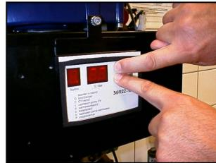
Die Schornsteinfegerfunktion wird aktiviert, indem die + und – Taste am Display gleichzeitig länger als 5 Sekunden gedrückt gehalten wird.
