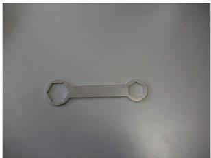
Das Überdruckventil sollte mit einem Drehmoment von 10 Nm festgezogen werden. Es empfiehlt sich die Verwendung des Spezialwerkzeuges für das Sicherheitsventil, Artikelnummer 190226.
