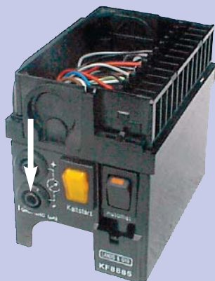
Messanschluss für die Flammenüberwachung
